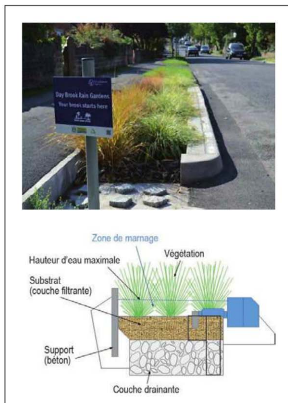
Figure 3. Photographie et schéma des jardins pluviaux mis en place
