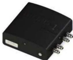
Nouveau matériel permettant la réalisation des procédures d'autocontrôle de tous les modèles de test à l'air de type Mistral. Système autonome incluant pompe électrique, réserve et capteur de pression étalonné permettant d'effectuer le contrôle en 10 minutes de 1 à 4 consoles. Un rapport contenant les mesures est établi pour chacun des systèmes testés.
