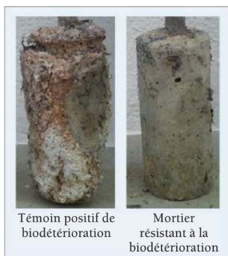
Figure 5. Photographies de l'état du témoin positif de détérioration et d'une éprouvette de mortier montrant un bon comportement après 1020 jours d'exposition à des conditions d'exposition excédant la classe XA3
