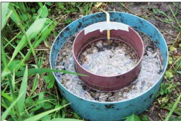
Figure 2. Perméamètre à double-anneau en fonction
