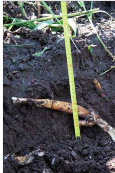
Figure 6. Coupe de l'horizon de dépôt sur le 1<sup>er</sup> étage du filtre (site A)
