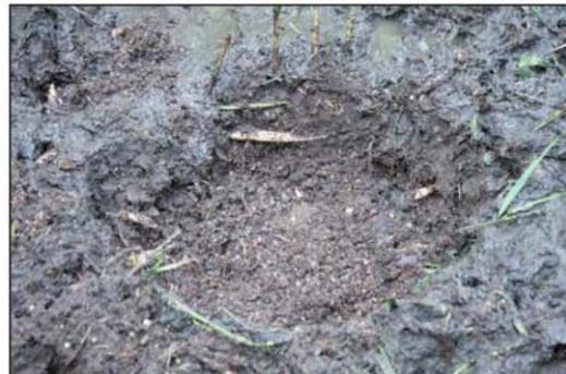
Figure 7. Coupe de l'horizon de dépôt sur le 2<sup>e</sup> étage du filtre (site A)
