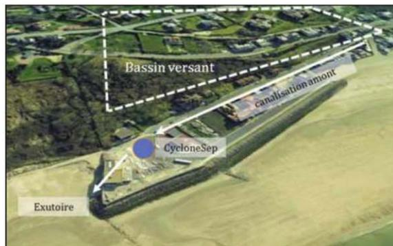
Figure 2. Configuration de l'installation du CycloneSep à Trouville/Mer
