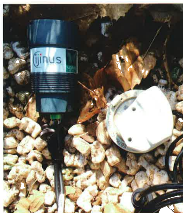
Logger Ijinus pour la télérelève de compteurs avec mesure de pression, communication Sigfox. Ijinus a substantiellement enrichi sa gamme de capteurs dédiés à la surveillance des réseaux et propose désormais une offre étoffée dans ce domaine.
