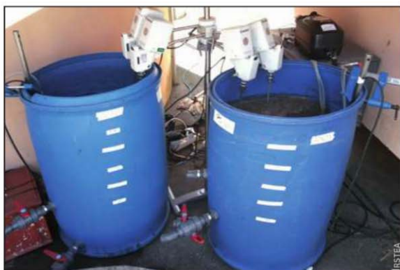
Figure 2. Photographie des deux réacteurs fermés (à gauche, réacteur aérobique agité et aéré; à droite, réacteur anoxique agité et non aéré)
