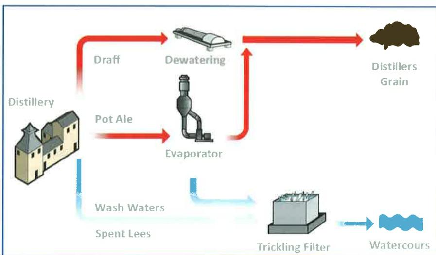
Diagramme 1: Schéma traditionnel du traitement des rejets dans une distillerie.
