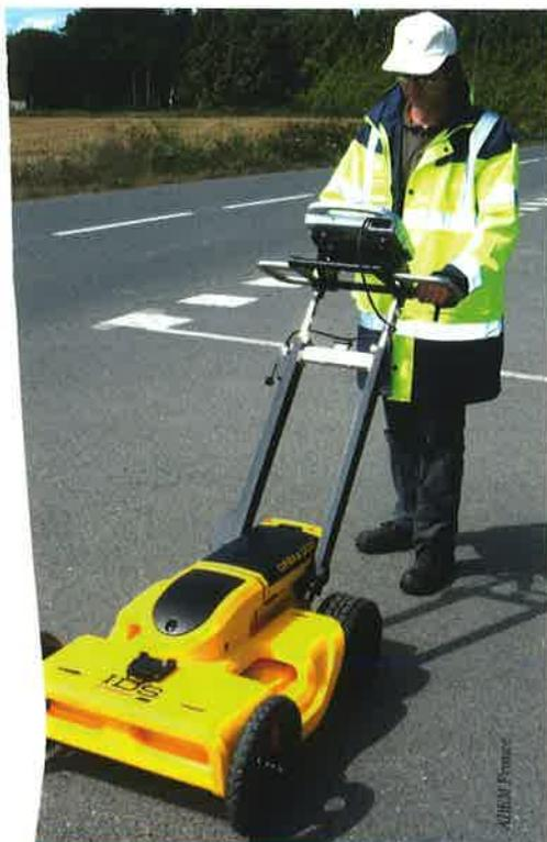
avec son antenne duale, l'Opera Duo d'Abem France permet une détection sur deux profondeurs en simultanée. L'antenne duale est très mobile de façon à épouser la forme du sol et à franchir facilement les obstacles. L'acquisition des données se fait à partir d'une tablette tactile qui permet la visualisation en temps réel des profils et l'enregistrement des données brutes.
