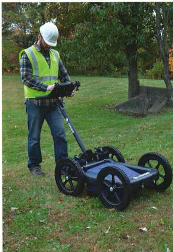
Le géoradar Quantum de My-NDS affiche en simultanée les trois fréquences comprises entre 250 Mhz et 1Ghz. Il permet donc une interprétation simplifiée et assure des performances sur tous types de sols jusqu'à 4 mètres. Ses quatre roues et son antenne biseautée en font un vrai radar tout terrain fiable et robuste. La tablette durcie Panasonic ou Getac est fournie. L'affichage en 3D, et l'acquisition des données GPS est possible.
