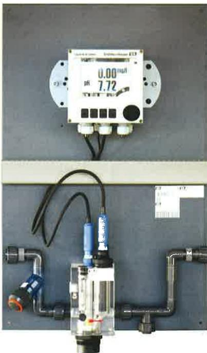
Le Chloromax CCS142D développé par Endress+Hauser, associé au transmetteur Liquiline, permet de mesurer le chlore libre actif. Grâce au montage sur platine, l'ensemble capteur/transmetteur est livré clé en main pour une mise en service et une maintenance facilitées.
