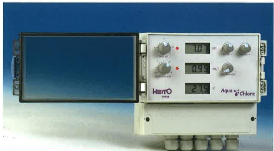
L'Aquachlore de Heito contrôle en continu la teneur en chlore actif, le pH et la température de l'eau. Cet appareil est utilisable dans de nombreux domaines tels que les réseaux d'eau potable, les circuits d'eau chaude, les piscines, grâce à une large plage de mesure (0,01 mg/l - 5 mg/l) de chlore actif. Le branchement en direct de deux pompes doseuses gère automatiquement la régulation du chlore et du pH.
