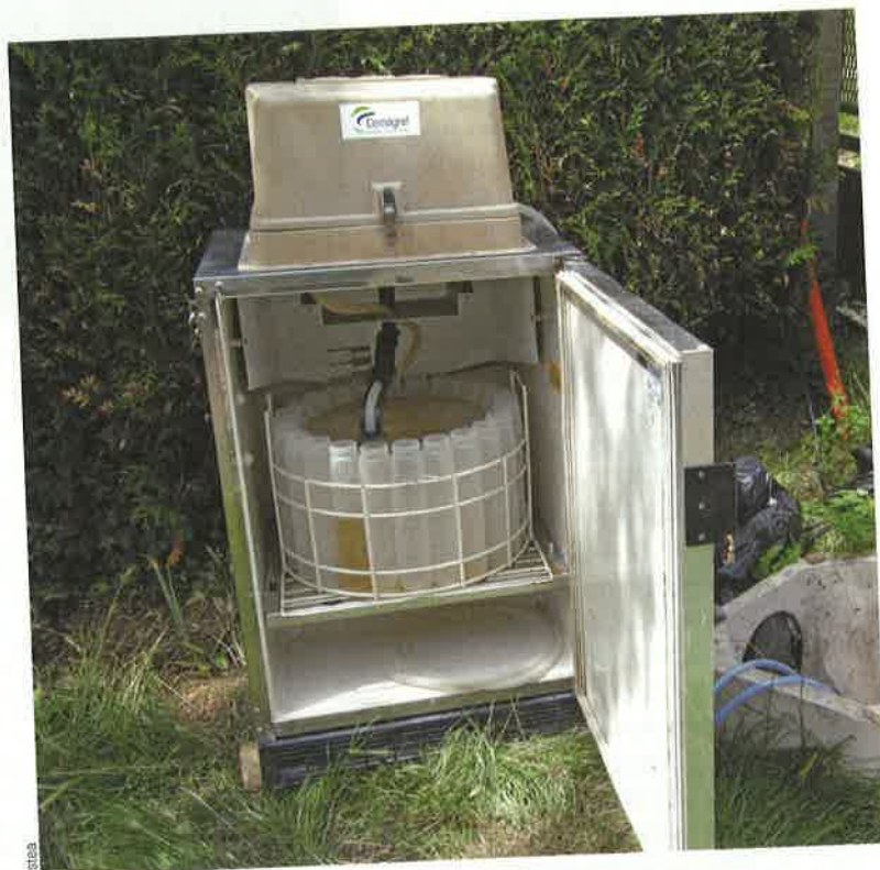
Ce préleveur aide à mesurer et à caractériser les effluents (débit et charge organique) et la qualité des rejets.
