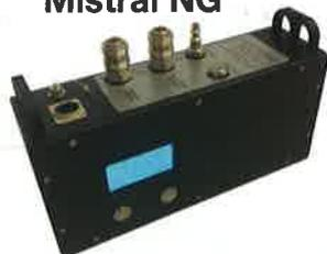
Mistral NG est un module de mesure permettant la réalisation d'essais d'étanchéité à l'air des ouvrages d'assainissement selon les protocoles de l'EN 1610 et cela de manière totalement automatisée : mise en pression, stabilisation, mesures et dépressurisation sont réalisées sans qu'aucune intervention de l'opérateur ne soit nécessaire.
