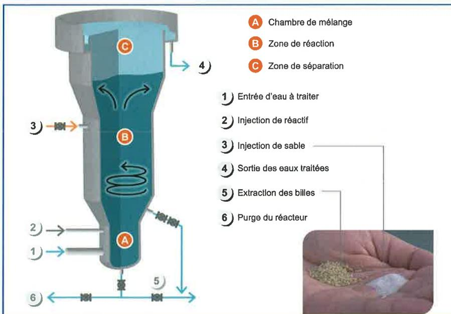
**Le Gyrazur est un réacteur de décarbonatation catalytique à lit fluidisé développé par les spécialistes du traitement de l'eau de SUEZ ENVIRONNEMENT.**
