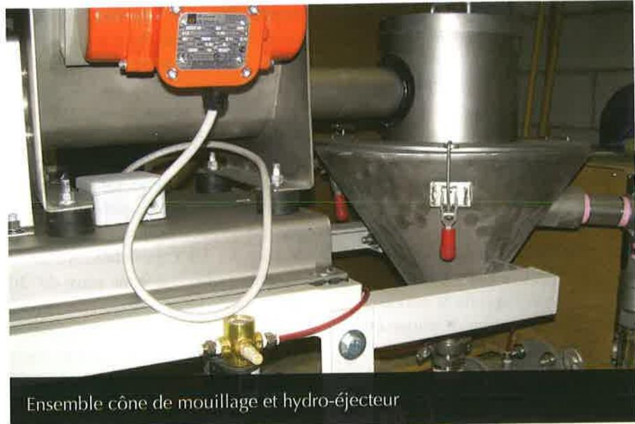
Ensemble cône de mouillage et hydro-éjecteur
