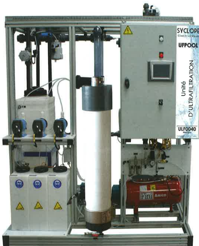
Le procédé d'ultrafiltration UFPool de Syclope Electronique se compose d'une décantation suivie d'une filtration membranaire avec une étape d'oxydation par injection d'hypochlorite de sodium.
