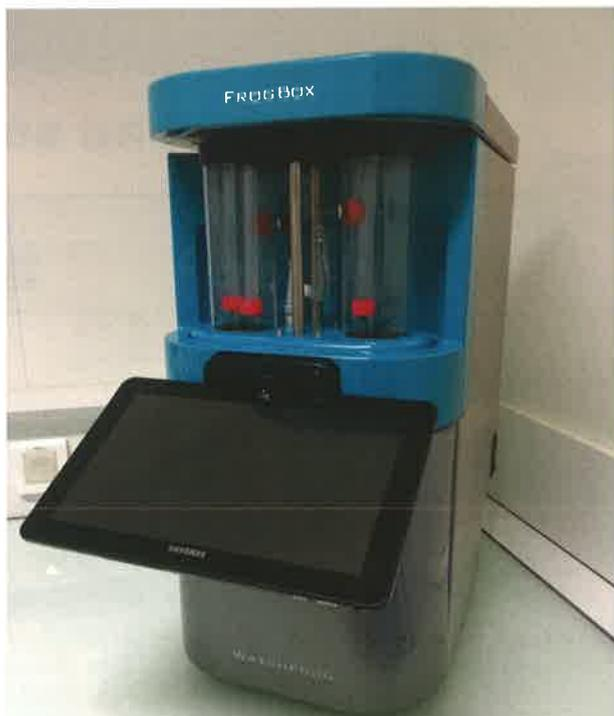
La FrogBox développée par WatchFrog en partenariat avec Veolia est un outil de mesure en continu des perturbateurs endocriniens. Tous les paramètres d'une lecture (température, vitesse du flux, prise d'images, et analyse d'image) sont contrôlés par une tablette tactile qui permet ainsi d'effectuer une analyse en direct en visualisant en temps réel le résultat des mesures.
