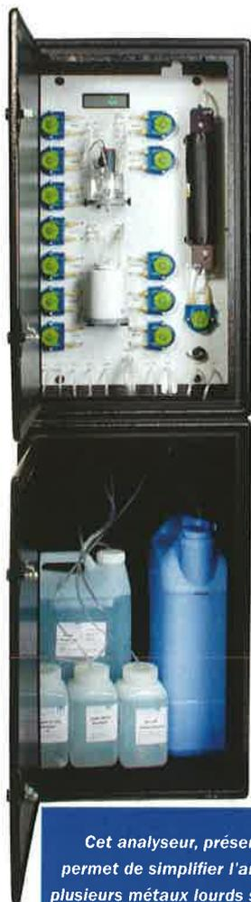
Cet analyseur, présenté par Mesureo, permet de simplifier l'analyse en analysant plusieurs métaux lourds simultanément. Il est aujourd'hui intégré sur des process industriels et en surveillance de rejets. L'investissement nécessaire a été divisé par deux par rapport aux instruments présents sur le marché il y a seulement cinq ans.
