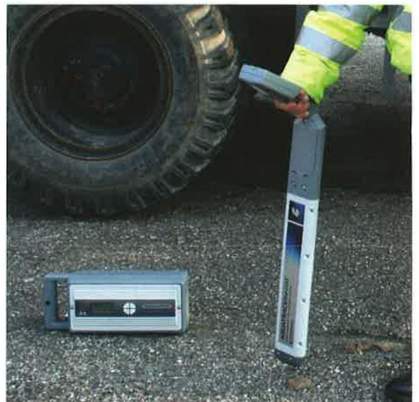
L'Aquatrac 5 Watts commercialisé par T.D. Williamson est un nouveau détecteur ferromagnétique multifréquences (de 512 Hz à 184 kHz) permettant de détecter facilement les conduites métalliques, en fonte. Parmi ses atouts, l'affichage automatique de la profondeur et un système de guidage pour aider au bon positionnement du récepteur au-dessus du câble ou de la conduite.
