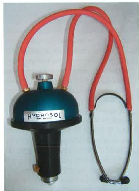
**L'hydrosol d'Anthalys, entièrement fabriqué en France, est un appareil acoustique simple permettant la recherche des canalisations enterrées sous pression comme la détection de fuites. Une vis de réglage agit sur la membrane et permet de moduler l'écoute. Cet appareil, reconnu depuis plus de 30 ans, ne nécessite pas d'entretien. Il est livré en coffret avec une pointe courte et une allonge de 1 m avec pointe.**
