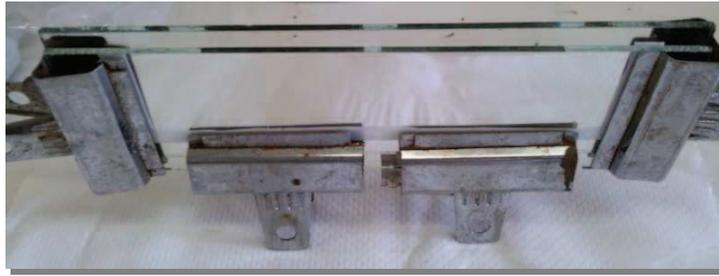
Figure 12 : Moule pour fabrication d'un gel diffusif (épaisseur 0,05 cm) et/ou d'une résine (épaisseur 0,025cm)
