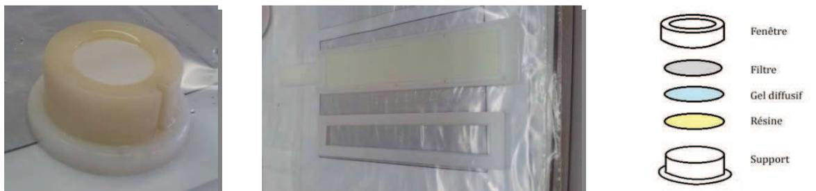
Figure 10 : DGT piston pour colonne d'eau (a), DGT sonde pour sédiment (b) et montage de la résine, du gel diffusif, du filtre et de la fenêtre sur support DGT piston (c)
