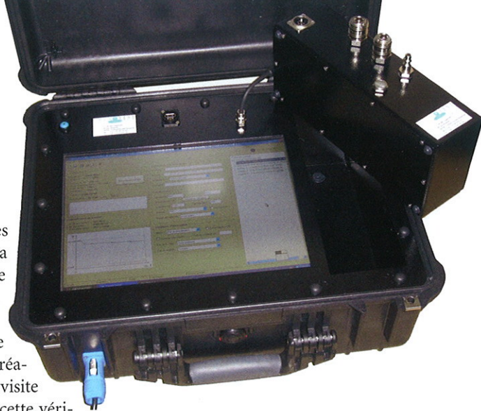
Matériel d'essais d'étanchéité Mistral NG (Createst).
