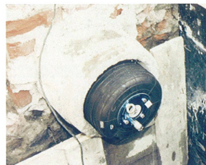
Obturbateur pour canalisation Vari Plug (Pronal).
