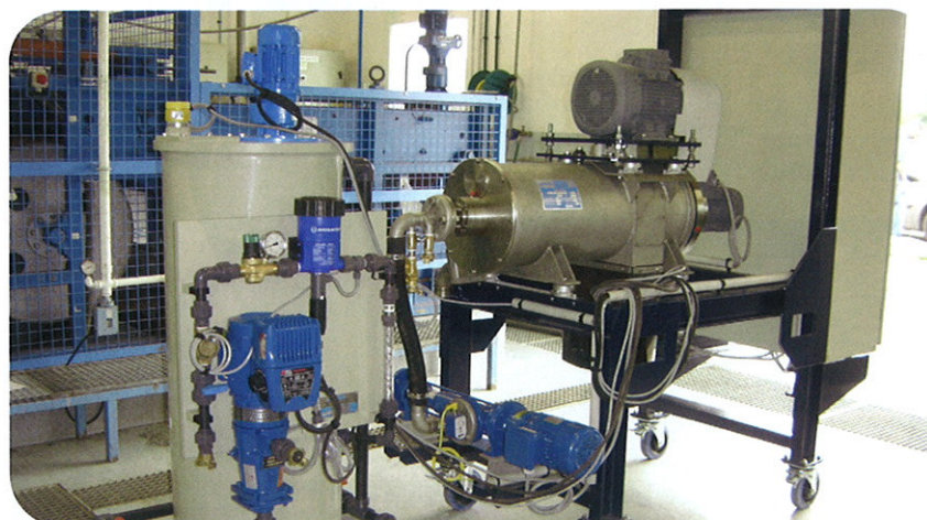
I Photo 3 : Centrifugeuse équipée de tous les automatismes et de son skid de préparation de polymère
