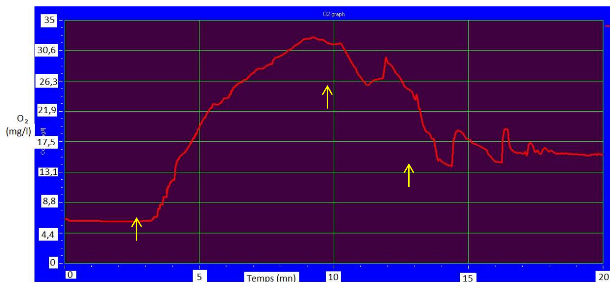
Figure 52 : [O_2] = f(t) après 3 injections successives de 0,5% d' H_2O_2 sur sol-gel
