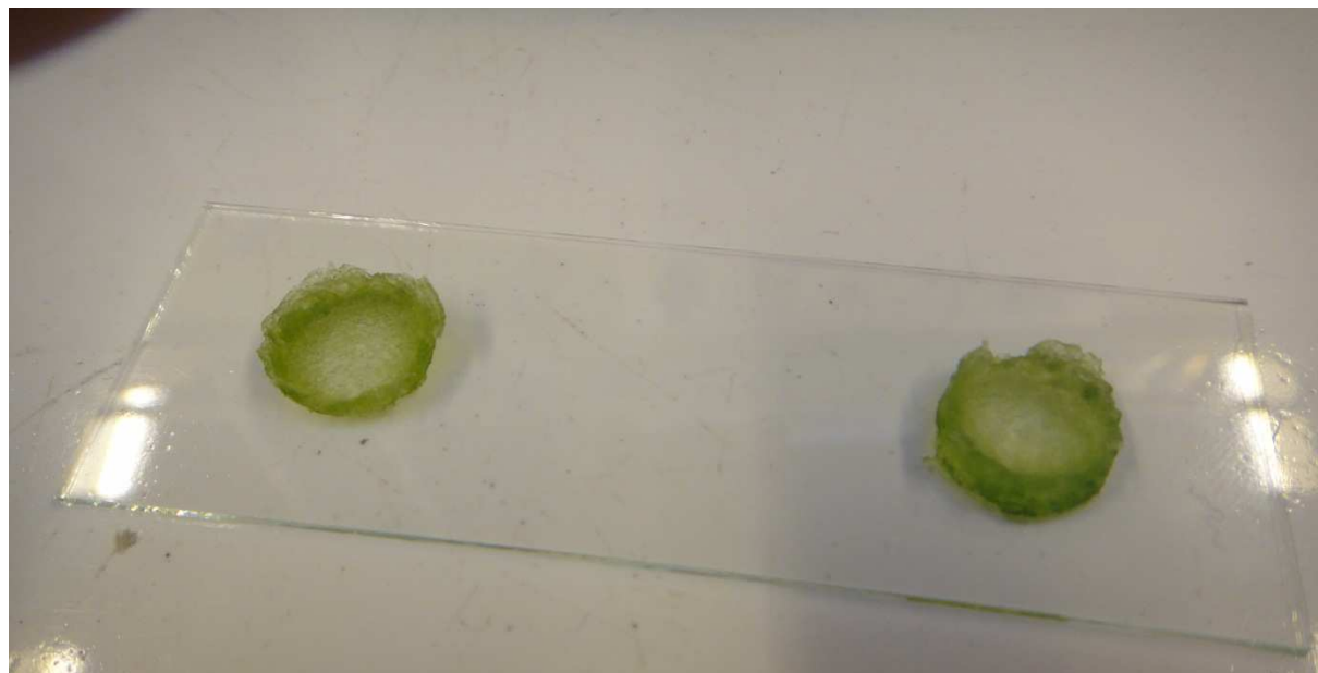
Figure 51 : membranes de matériau sol-gel contenant la souche d'algues CR
