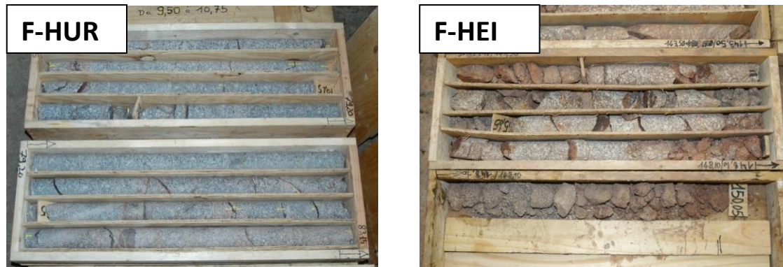
Figure II-2 : photos d'une partie du profil carotté dans le granite porphyroïde, à gauche le granite prélevé le long du profil F-HUR et à droite le granite prélevé dans le puits F-HEI.
